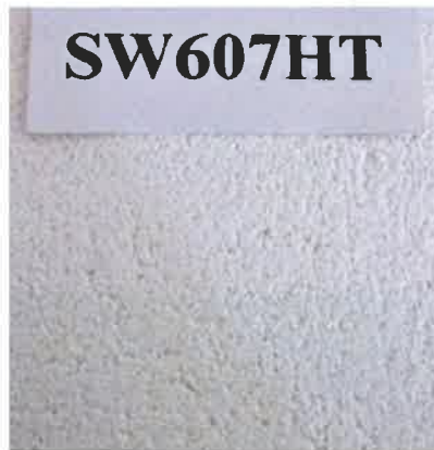
ペーパーを取り去った後： 1,260°Cx24時間加熱でレンガには反応の様子が見られない
